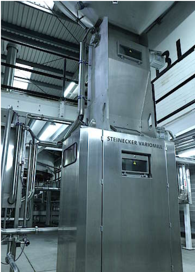
Malzmühle von Teeling
